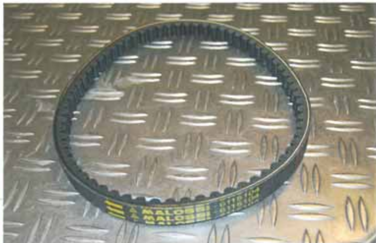
De oh zo cruciale verbinding tussen de voor- en achter poelies, de v-snaar
