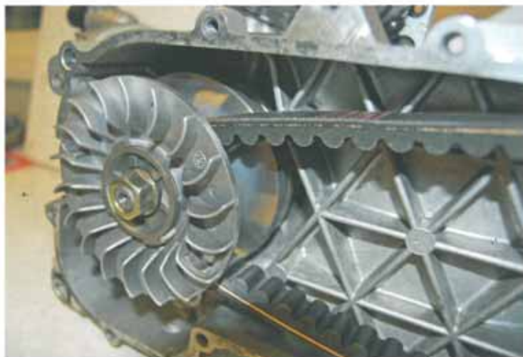
De laag hangende v-snaar. Dit betekent dat de scooter of wel in rust- of deellast wordt gebruikt
