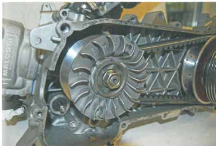
Een close up van de voorste poelies, goed te zien is de variateur en de voorste poelie welke tevens voor de koeling zorgt
