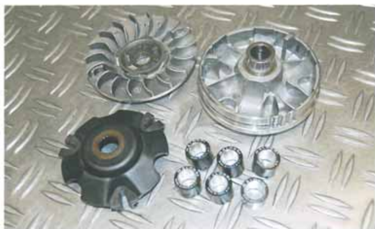
De voorste poelies bestaande uit: de variateur plus rollen, gradenplaat en de voorste poelie
