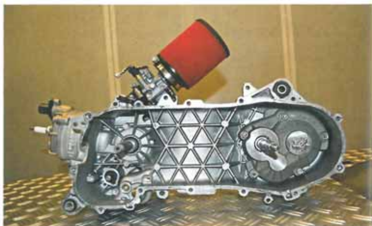
Een 'kaal' blok waarvan de voorste en achterste poelies als ook de v-snaar zijn verwijderd
