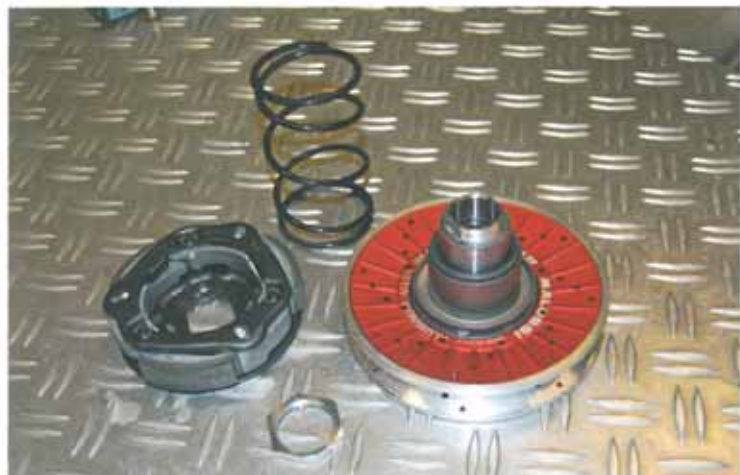
De achterste poelies samen met de drukveer en de centrifugaalkoppeling
