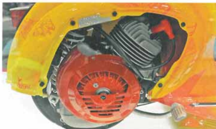
Vorbildliches Tuning wie aus dem Lehrbuch. Diesen Satz kann man getrost so stehen lassen. Schade, daß der schön verrippte Zylinder später unter der Kühllufthaube verschwinden muß
