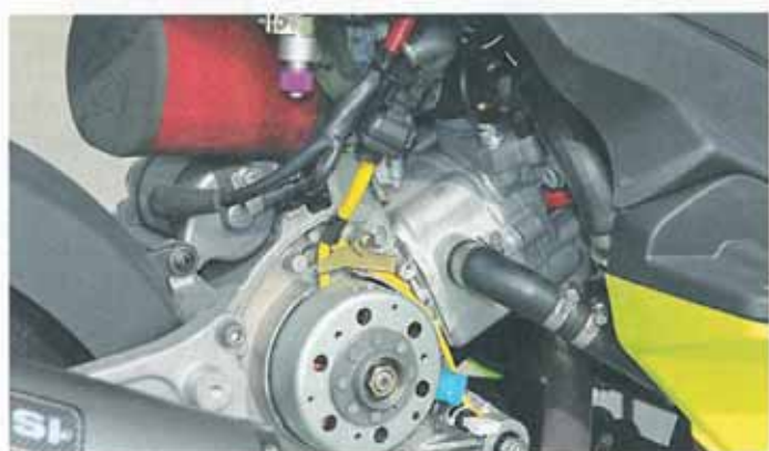
Mehr Hubraum, 209 statt 124 Kubik, führt zu mehr Druck
