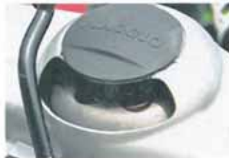
So kommt Luft zur Kupplung
