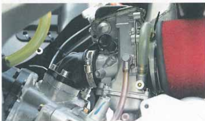
Flachschiebervergaser mit 34 mm Durchmesser
