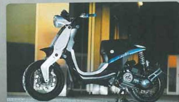
Polini ha ido más allá de lo convencional aplicando varias soluciones para crear una pieza única: la Vespa Future Style contaba con componentes Polini como unos amortiguadores regulables, un silenciador en aluminio, un grupo térmico que incluía el carburador y la centralita o un variador Polini Maxi Hi-Speed ampliado a 118 milímetros.
