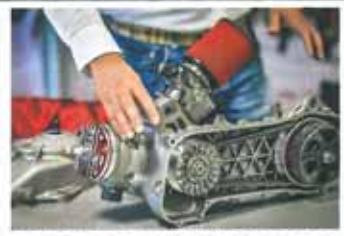
▲こちらがRC-ONEが組み込まれたエアロックスのエンジン。マロッシのコンセプトはとにかくパワーを追求すること。その増強されたパワーに対応して耐久性も確保するために、設計のみならず金属素材から厳選することによって、トータルでのハイパフォーマンスを目指しているのだ。
