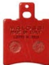
Il materiale di attrito delle pastiglie Brake Pads MHR è realizzato con fibre a base completamente organica e assolutamente prive di amianto.
