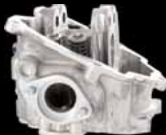
Condotto scarico aumentato del 25%
