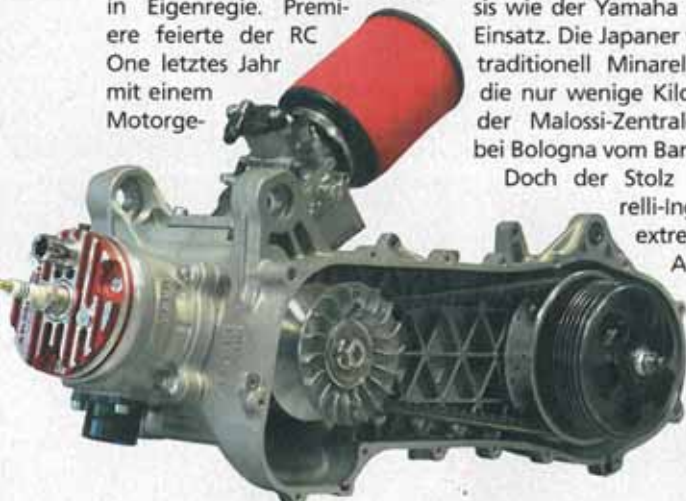
Malossi Rennmotor RC One für Yamaha. Alle Teile vom Zylinderkit bis zum Getriebe sind identisch mit denen fürs Piaggio-Gehäuse
