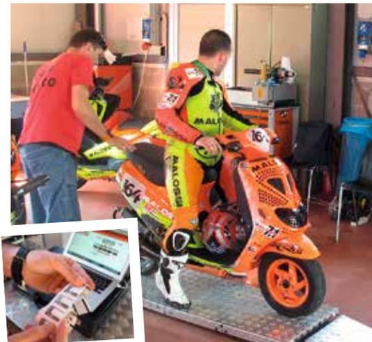
Bei der technischen Abnahme vor und nach den Rennen werden relevante Bauteile mit Barcodes markiert
