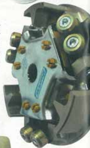
Fliehkraft läßt sich auch anders zur Übersetzungsänderung nutzen als mit tonnenförmigen Gewichten. Das beweist die exotische Variomatik von J.Costa (oben) mit ihren Madenrollen, während Doppler feste Kippgewichte einsetzt
