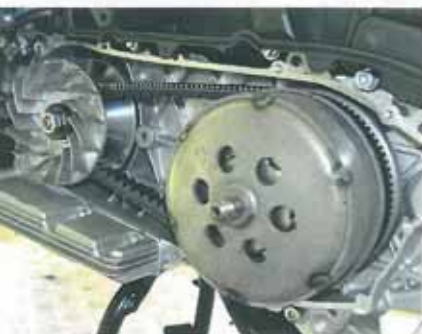
Selbst ein vergleichsweise schwacher Medley 125 besitzt heute einen doppelt verrippten Keilriemen
