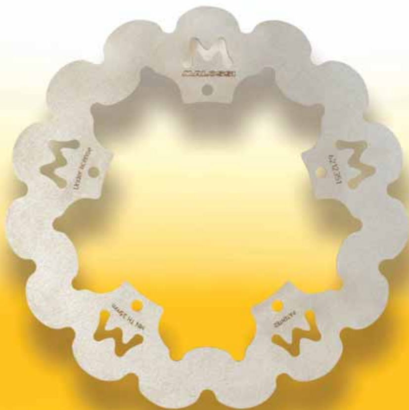
Profilo definito al CAD, calcolato per rasare completamente la superficie del materiale d'attrito
